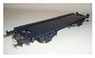
Die angespritzten Griffstangen in Kunststoff werden ans Gehäuse entfernt und durch 0.8 mm Draht ersetzt.
